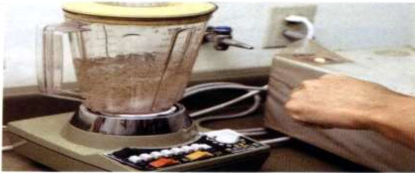
٨. توضع العينة في خلاط منزل ويضاف إليها ٣/١ من حجم زجاجة الخلاط بالماء ويتم تشغيل الخلاط لمدة ٢ دقيقة
