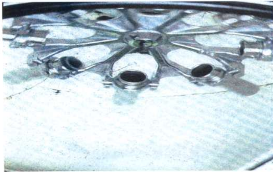
١٤ . يتم تشغيل جهاز الطرد المركزي لمدة ٤ دقائق على سرعة ٣٦٠٠ دورة في الدقيقة.
