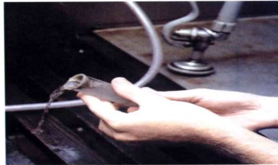
١٥ . يتم استخراج العينات من جهاز الطرد المركزي ويتم التخلص من الجزء العلوى من العينة بمنتهى الدقه.
