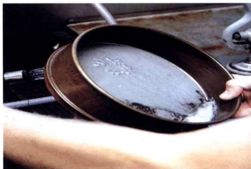
٩ . تغسل المصفاه من الخلف بواسطة رشاش ماء ضعيف حتى تتركز العينة في أحد جوانب المصفاه.
