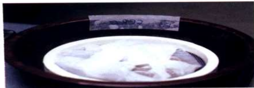
١٦. يتم إغلاق ورقة الكلينكس على العينة ويضاف رقم العينة وتترك لمدة ٢٤-٤٨ ساعة في المعمل بعد ذلك يتم التخلص من ورقة الكلينكس وعليها الجذور وتصب محتويات الطبق في المنخل ثم الى طبق بترى
