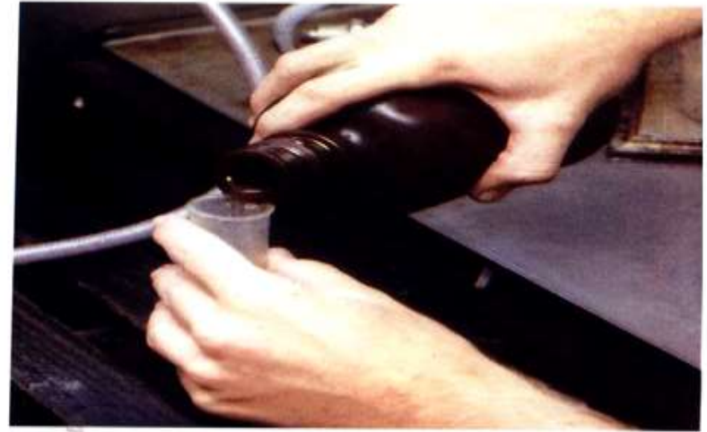
١٧. يضاف المحلول السكري (بتركيز ٥٠٠ جرام من السكر لكل لتر ماء) إلى أنبوبة الطرد المركزي التي تحتوى على التربة.
