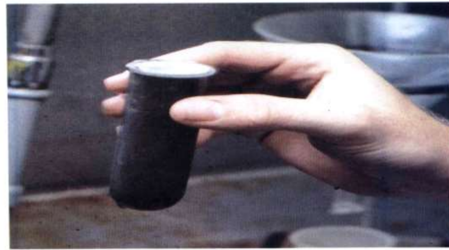
١٣ . شكل لأنبوبة جهاز الطرد المركزي وبها العينة وترقم الأنبوبة برقم العينة ويتم تكرار الخطوات السابقة، حتي يصل إلى ثمانى عينات وهم عدد أنابيب الطرد المركزي فى الدورة الواحدة.
