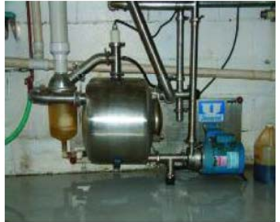
شكل ( 8 - 9 ) مضخة التفريغ مع مقياس مستوى تخلخل الضغط
