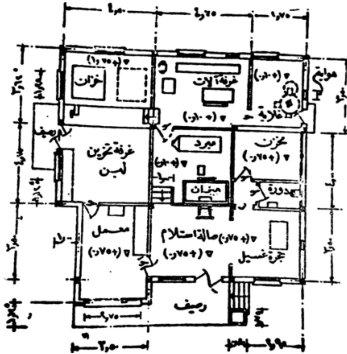
مركز تجميع اللبن في إحدى الوحدات المجمعة هندسة مزارع الإنتاج الحيواني والدواجن د/محمود حسن علي حسن
